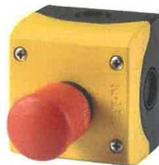
*Important : la coupure va s'effectuer à l'aide d'un dispositif électromécanique. Car un principe de coupure électronique (semi-conducteur) n'assure pas une isolation suffisante pour garantir la sécurité contre les contacts directs.*
